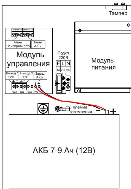
**Внимание!** Не допускается подменять защитное заземление занулением. Сечение провода защитного заземления не менее 2,5мм<sup>2</sup>. **Защитное заземление подключается к клемме заземления (Рис.1).** Для подключения блока питания к сети 220В использовать гибкий провод, соответствующий ГОСТ7399-80 и имеющий двойную изоляцию. Номинальное сечение провода не менее 1,5 мм<sup>2</sup>. Провод для подключения к сети 220В и заземления не входит в комплект поставки.
