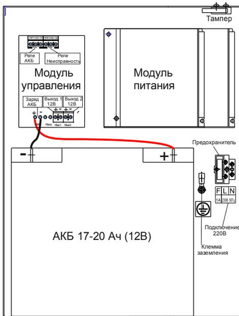
**Внимание!** Не допускается подменять защитное заземление занулением. Сечение провода защитного заземления не менее 2,5мм<sup>2</sup>. **Защитное заземление подключается к клемме заземления (Рис.1).** Для подключения блока питания к сети 220В использовать гибкий провод, соответствующий ГОСТ7399-80 и имеющий двойную изоляцию. Номинальное сечение провода не менее 1,5 мм<sup>2</sup>. Провод для подключения к сети 220В и заземления не входит в комплект поставки.
